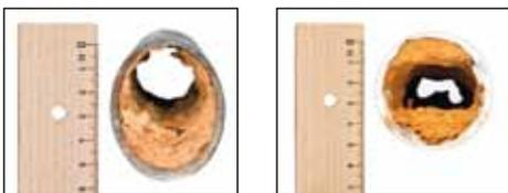
**Das Problem: Von außen nicht sichtbare Ablagerungen in Trinkwasserleitungen verursachen schon nach wenigen Jahren verkappte Schäden**
