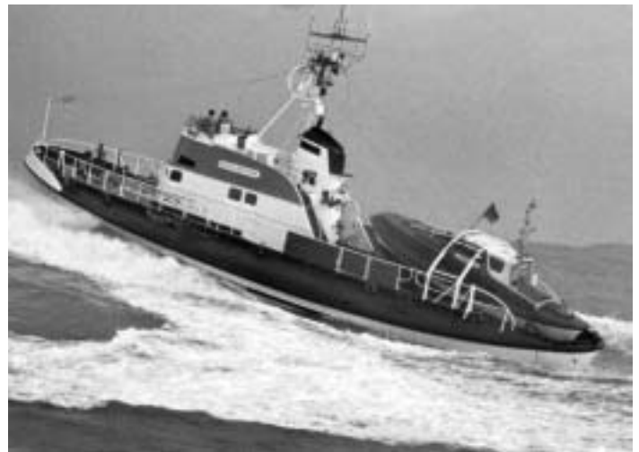
Der Seenotkreuzer Georg Breusing (26 Meter lang, 2.400 PS, 35 Stundenkilometer) war von 1963 bis 1988 von Borkum aus im Einsatz und liegt heute als Museumsschiff und technisches Denkmal in Emden. Foto: DGzRS
