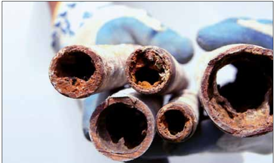
Das muss nicht sein! Kalkablagerungen und Rost können Trinkwasserleitungen verengen. Im schlimmsten Fall kommt es zum "Rohrinfarkt".
